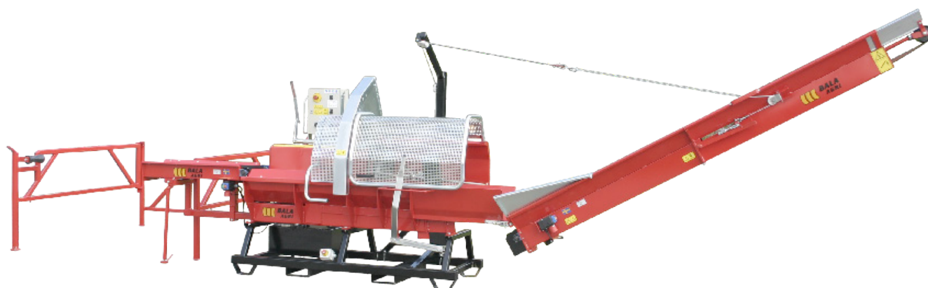
Bilden visar en maskin utrustad med stockbord, inmatning och transportör. Stockbordet kan ställas på valfri sida om inmatningen.
